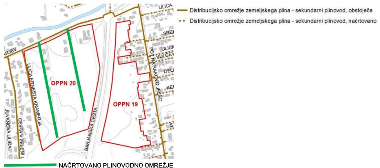
Slika 24: OKVIRNA zasnova plinovodnega omrežja
