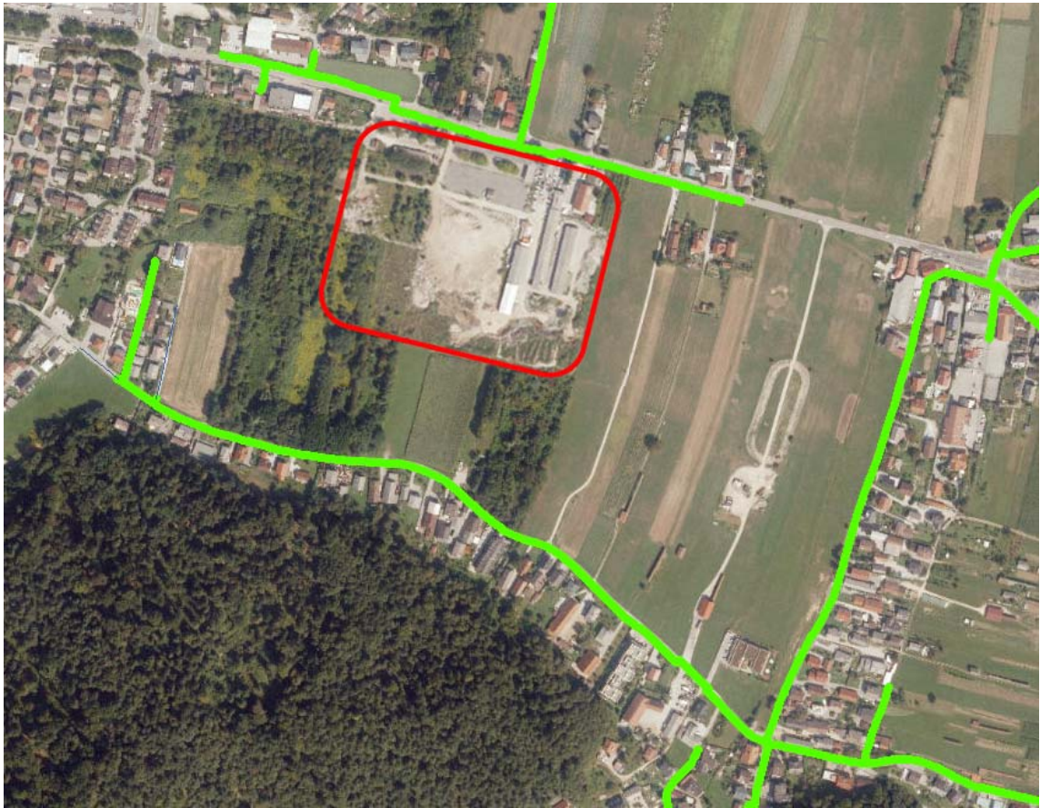
Slika 15: Prikaz poteka vodov in objektov plinovodnega omrežja (osnutek SD OPPN MOL ID); Vir: LUZ d.d.
